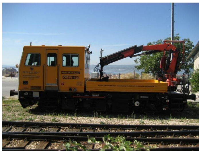
Slika10. Teška motorna drezina Plasser&Theurer OBW-10.057, [7]
