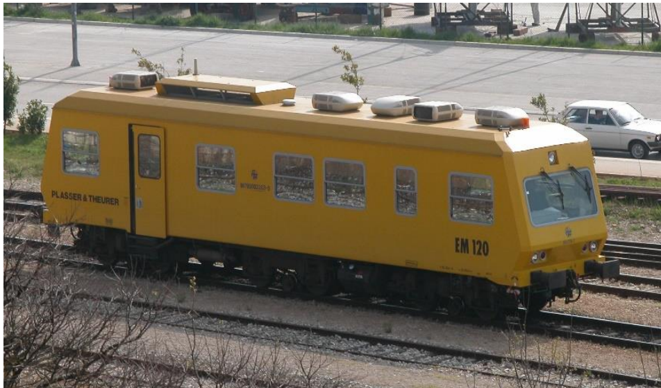
Slika 2. Tračničko mjerno vozilo EM-120, [6]
