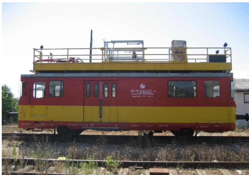
Slika 16. Teška motorna drezina tipa 300 "Boris Kidrič" Maribor, [11]
