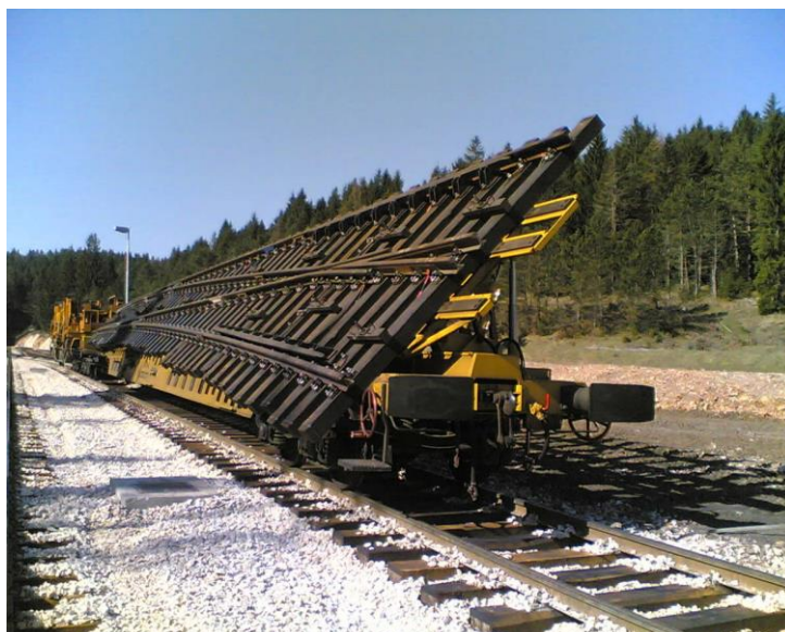
Slika 7. Vozilo za prijevoz skretnice, [8]
