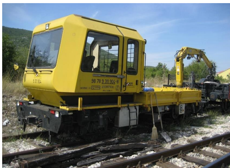
Slika13: Teška motorna drezina SKL 26, [9]
