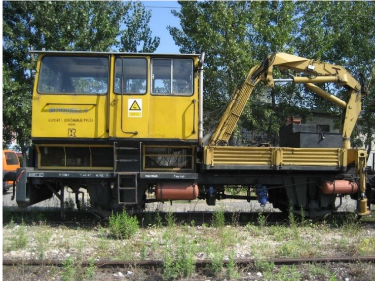
Slika14: Teška motorna drezina Geismar, [9]
