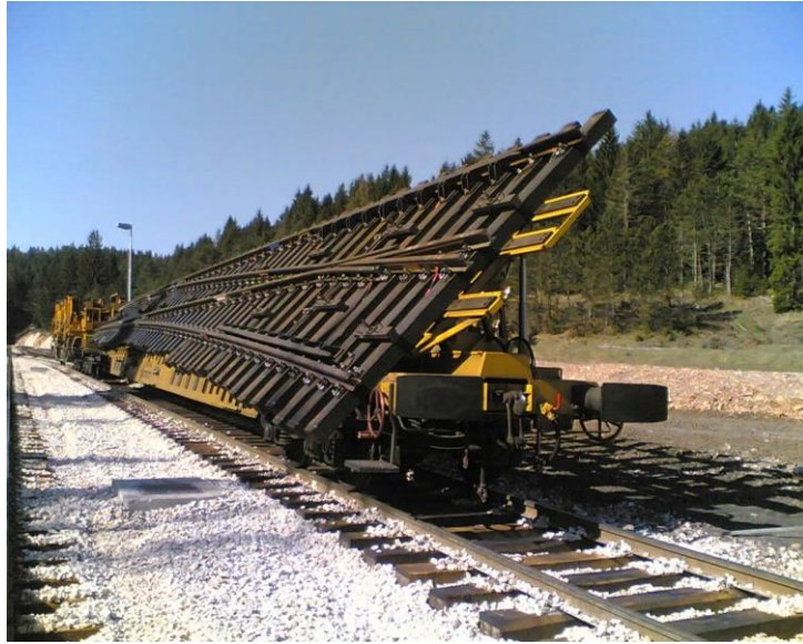
Slika 7. Vozilo za prijevoz skretnice, [8]
