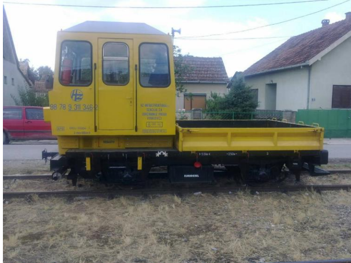
Slika 12. Teška motorna drezina SKL 25, [9]
