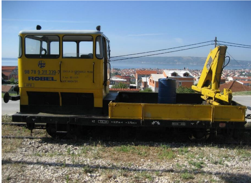
Slika 11. Teška motorna drezina Robel, [9]
