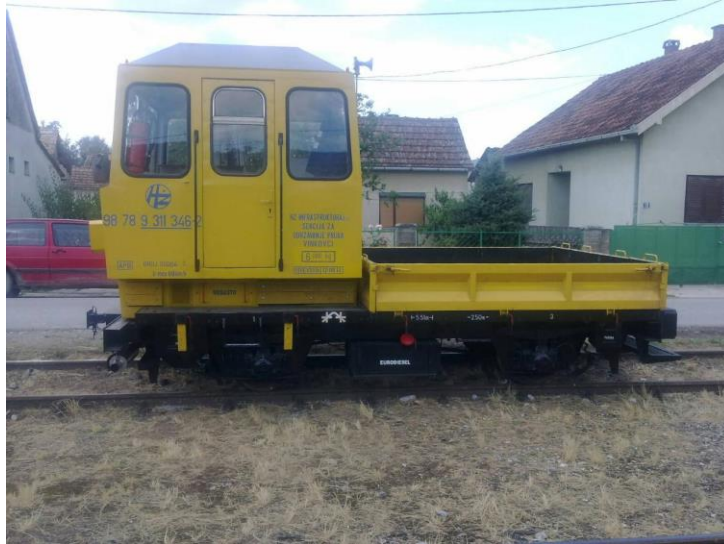
Slika 12. Teška motorna drezina SKL 25, [9]
