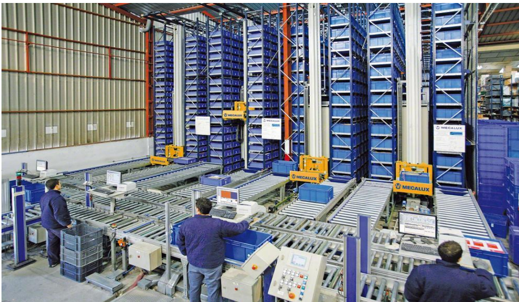
Slika 10. Prikupljanje manjih jedinica AR/RS sustavom
