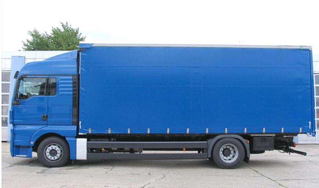
Slika 6. Kamion vozilo s vrstom nadgradnje- cerada
