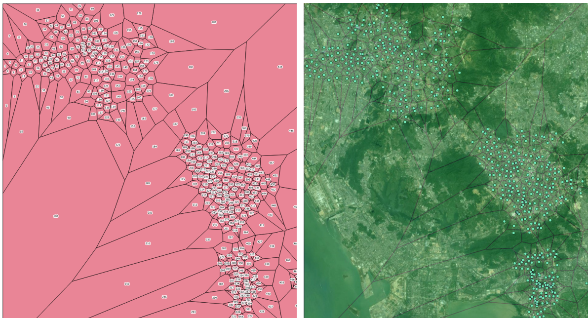
Slika 78. Dekompozicija prostora na Voronojeve ćelije (lijevo) i preklapanje s kartografskom podlogom Google Maps (desno)
