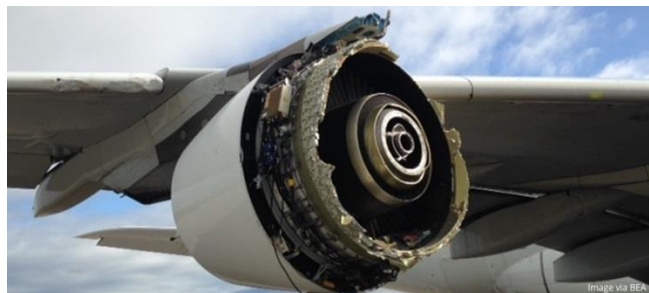
Slika 4.1: Motor Air Franceovog Airbusa A380 nakon nezadržanog otkaza motora
