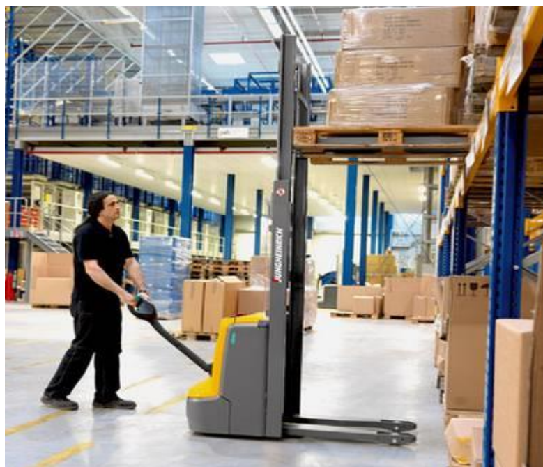
Slika 8. Prikaz manipuliranja s ručnim baterijskim viličarom s kranom
