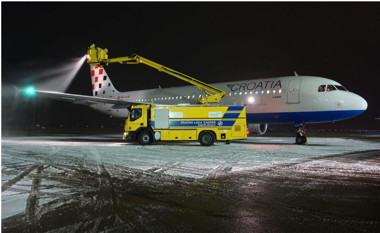
Slika 5. Zaštita zrakoplova od zaleđivanja
