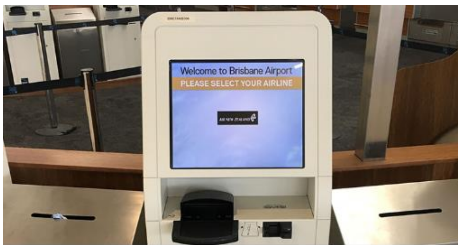
Slika 18. Samoposlužni biometrijski uređaj registracije na let
