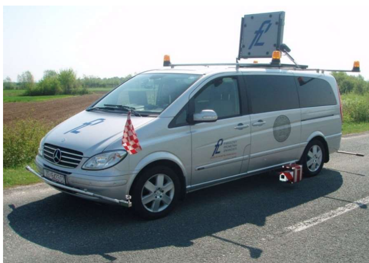
Slika 40. Mjesto vozilo sa Zavoda za prometnu signalizaciju Fakulteta prometnih znanosti, Sveučilišta u Zagrebu s montiranim dinamičkim retroreflektometrom
