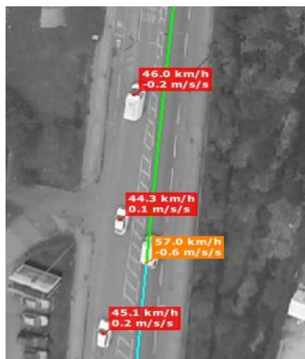
Slika 26. Prikaz mjerenja brzina [11]
