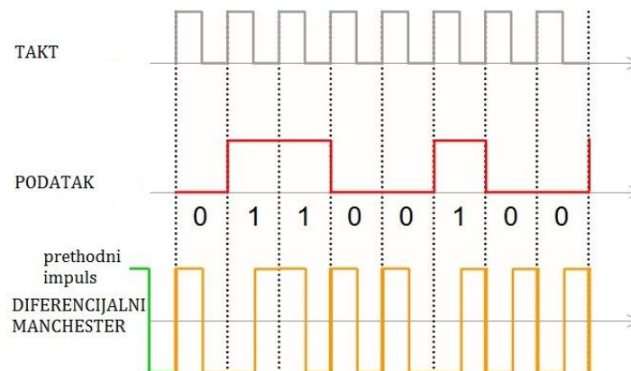
Slika 7. Diferencijalno Manchester kodiranje, [5]
