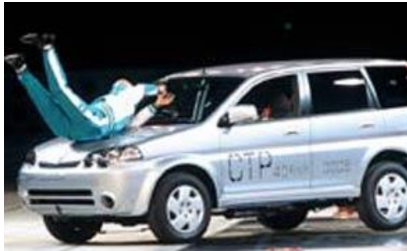
Slika 14. Poklopac motora za zaštitu pješaka[29]
