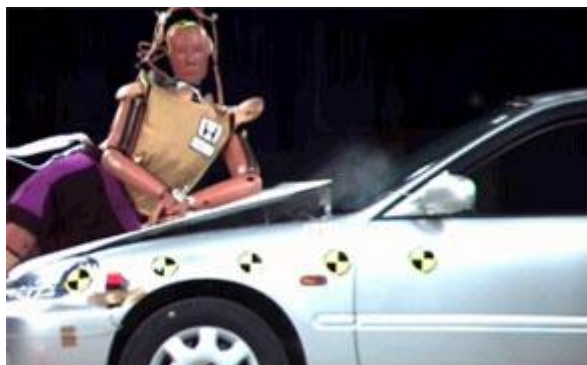
Slika 15. Poklopac motora prilikom udara pješaka[29]
