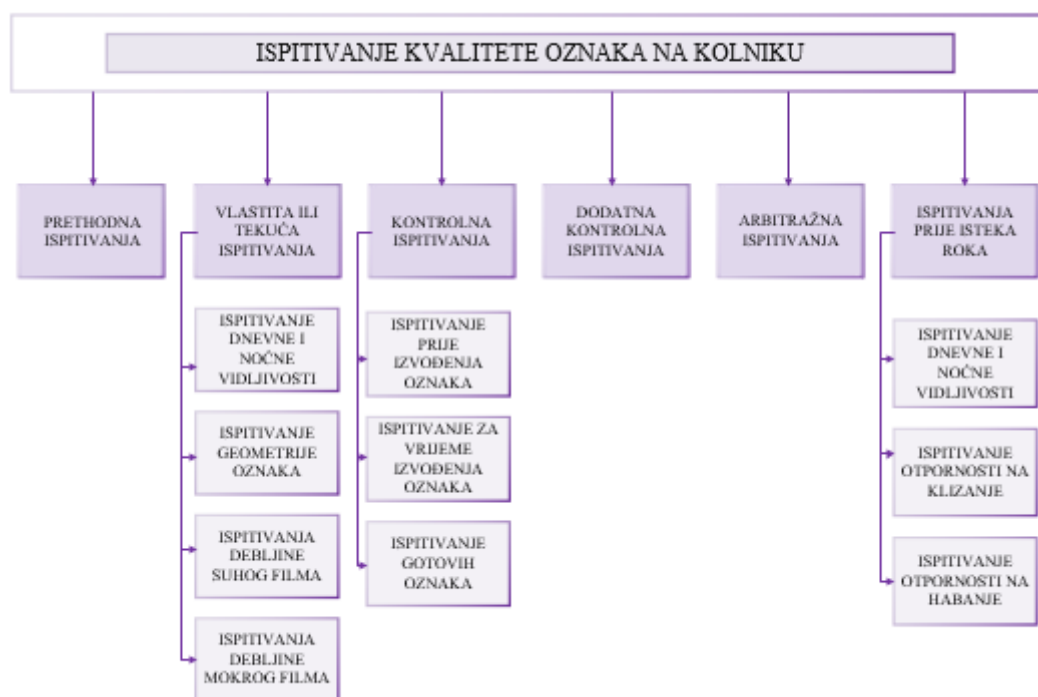
Slika 35. Vrste ispitivanja kvalitete oznaka na kolniku
