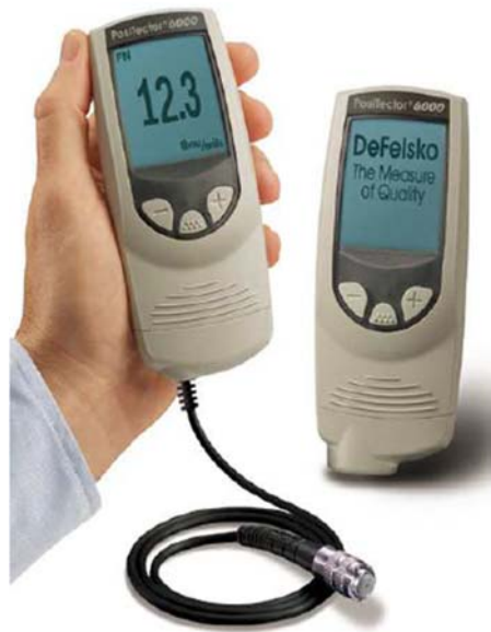
Slika 33. Uređaj za mjerenje debljine suhog filma boje
