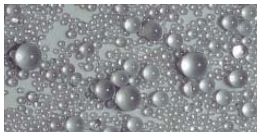
Slika 26. Megalux-beads staklene kuglice
