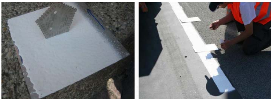
Slika 34. Ispitivanje mokrog filma boje
