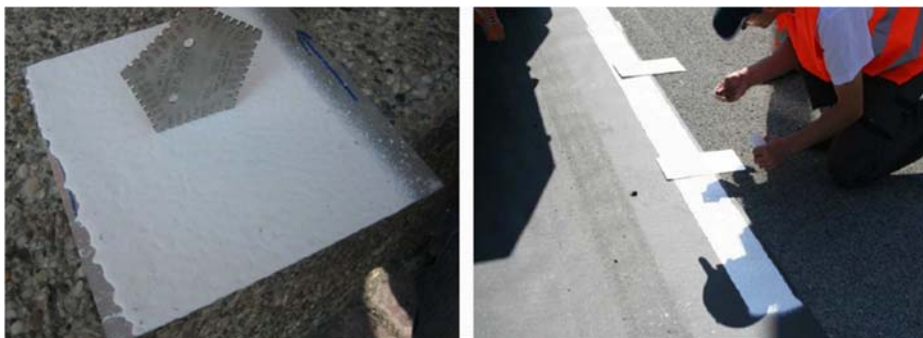
Slika 34. Ispitivanje mokrog filma boje
