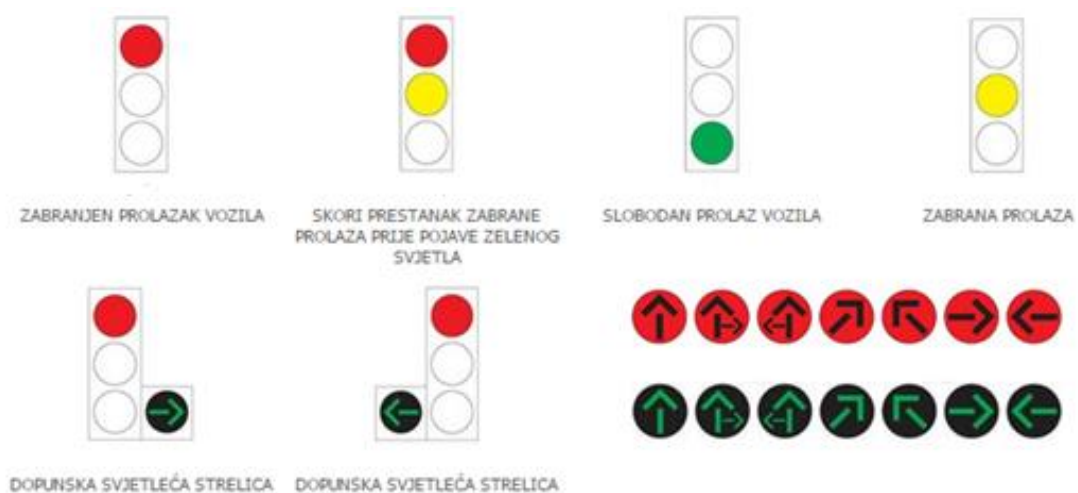
Slika 17. Signali za motorna vozila te prikaz oblika strelica, [9]
