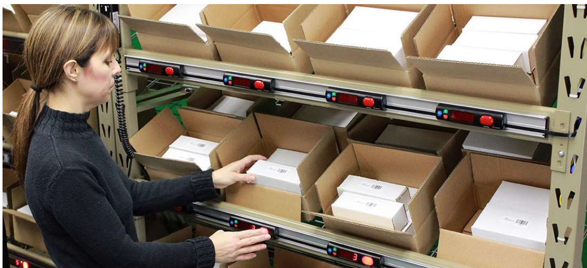
Slika 10.: Prikaz uporabe „pick to light“ sustava
