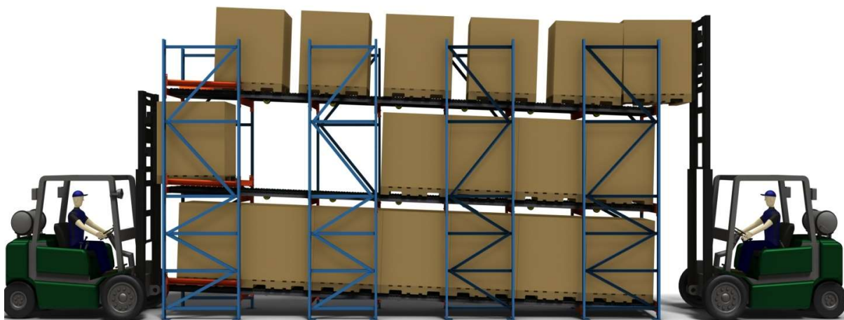
Slika 5. Prikaz protočnih regala sa kotačićima
