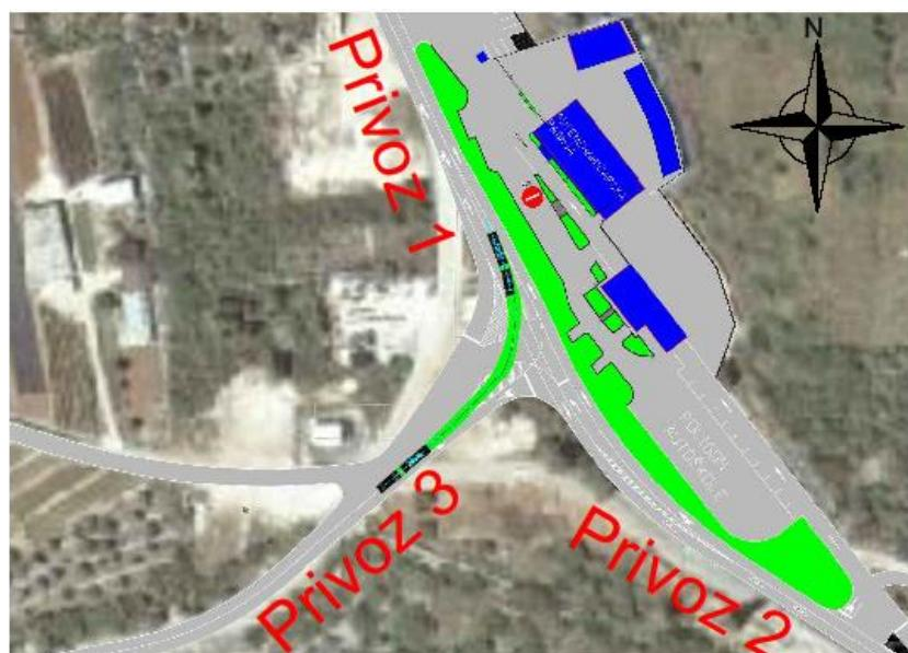
Slika 4.6. Provjera trajektorije mjerodavnog vozila na Ž6222
