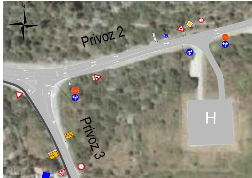
Slika 4.15. Rješenje priključka heliodromu
