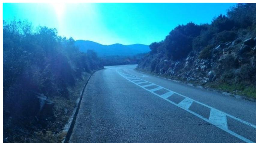
**Slika 3.22.** Smanjena preglednost kod nailaska na raskrižje, nailazak na raskrižje D118/Ž6222 u smjeru zapada u usjeku, trak za lijeve skretače
