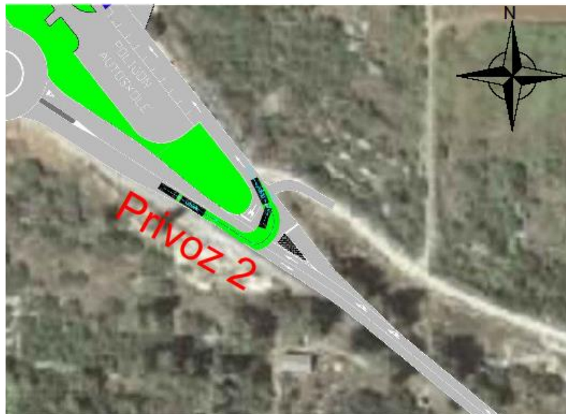
Slika 4.13. Mjerodavno vozilo zakretanja na rekonstruiranom priključku
