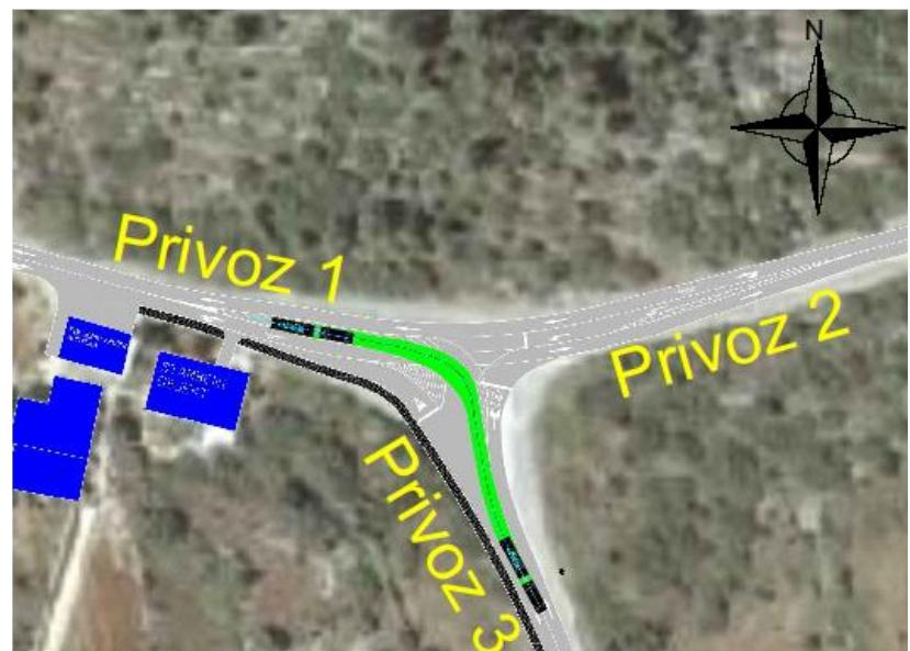
Slika 4.5. Provjera trajektorije mjerodavnog vozila na D118
