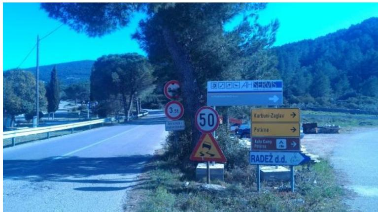
**Slika 3.17.** Znakovi: B23 – zabrana prometa za vozila čija ukupna visina premašuje visinu od 3.8 metara, B24 – zabrana prometa za vozila čija ukupna masa prelazi masu od 3.5 tona, dopunska ploča s natpisom „Osim za vozila s posebnom dozvolom“, B31 – ograničenje brzine od 50 km/h, A20 – sklizak kolnik, C28 – putokaz Karbuni-Zaglav, Potirna, putokazna ploča za usmjerenje prema autokampu, putokazna ploča za usmjeravanje prema brodogradilištu.
