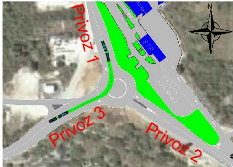
**Slika 4.8.** Provjera trajektorije mjerodavnog vozila na RKT Ž6222/LC69016/Ž6222
