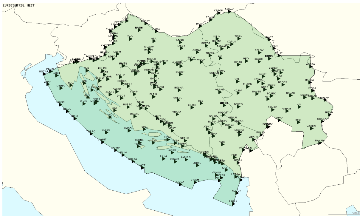
SLIKA 8. 2D PRIKAZ SEAFRA H24 PROSTORA S IMENIMA NAVIGACIJSKIH TOČKA [1]
