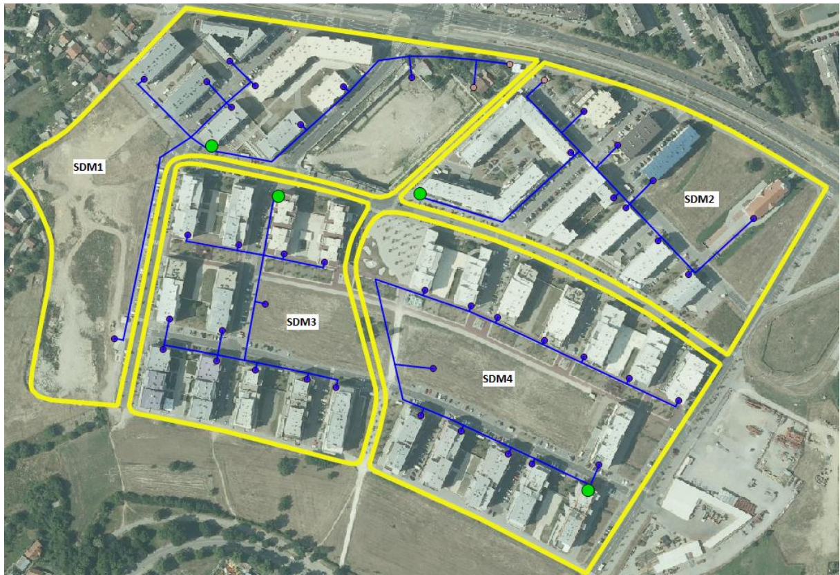
Slika 31. Svjetlovodna distribucijska mreža sa pripadajućim elementima
