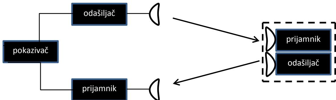
Slika 6. Blok shema radara sa aktivnim odjekom, [1]
