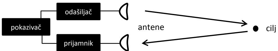
**Slika 3.** Impulsni radar sa pasivnim odjekom, [1]
