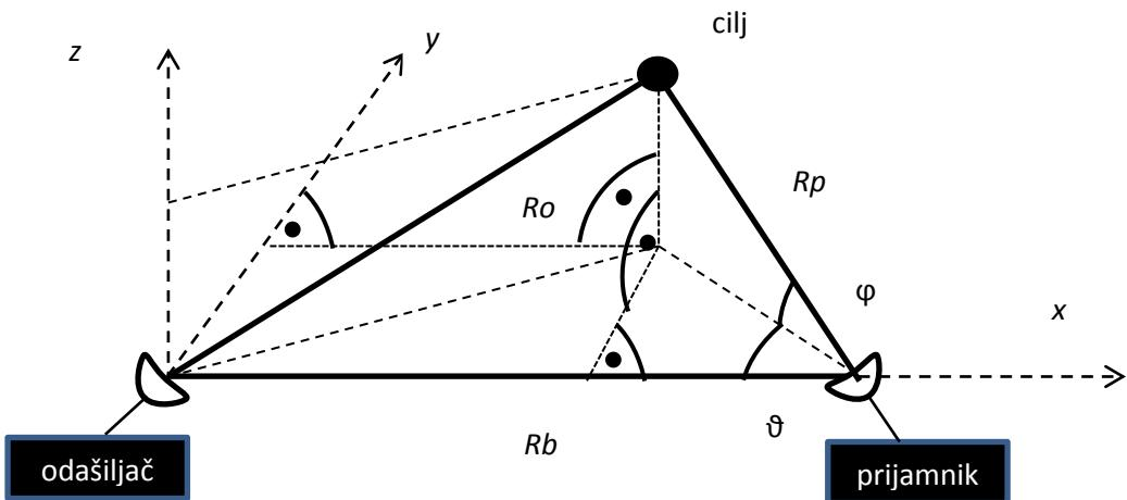
**Slika 7.** Princip određivanja cilja kod bistatičkog radara, [1]
