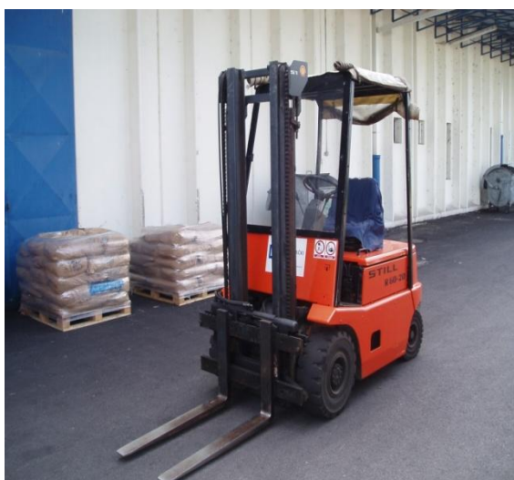
Slika 9: Viličar električni 2-t
