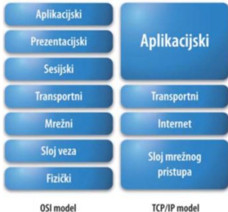
Slika 2. Razlika OSI i TCP/IP modela po slojevima [1]
