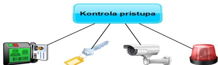
Slika 13. Elementi za postizanje kontrole fizičkog pristupa
