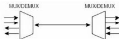
Slika 16. Dvosmjerni DWDM sustav
