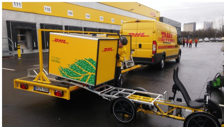
**Slika 19.** Koncept „City Hub“ (proces istovara/utovara kontejnera)
