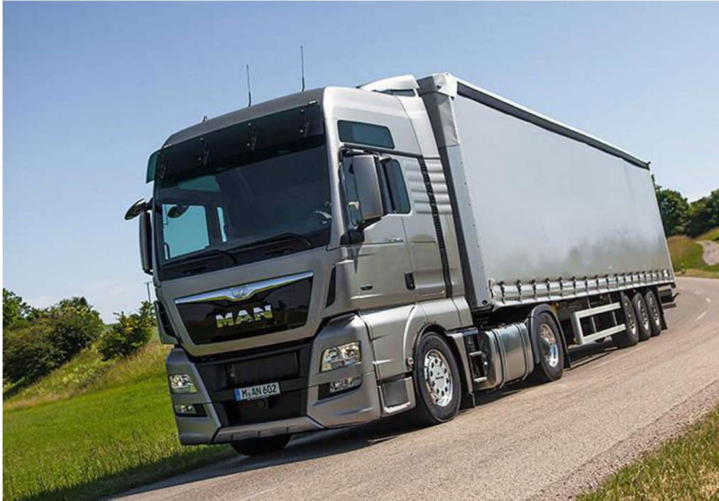
Slika 6. Tegljač s dvije osovine i poluprikolica s tri osovine
