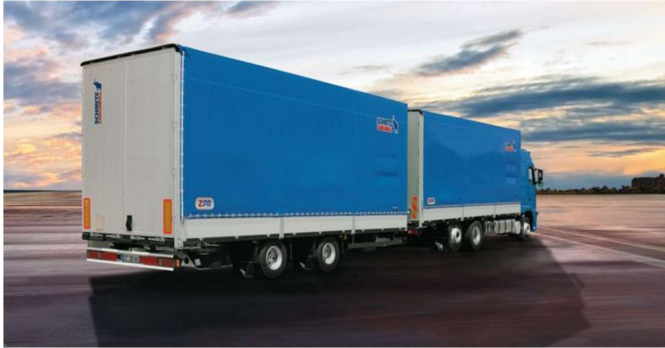
Slika 5. Kamion s tri osovine i prikolica s dvije centralno smještene osovine
