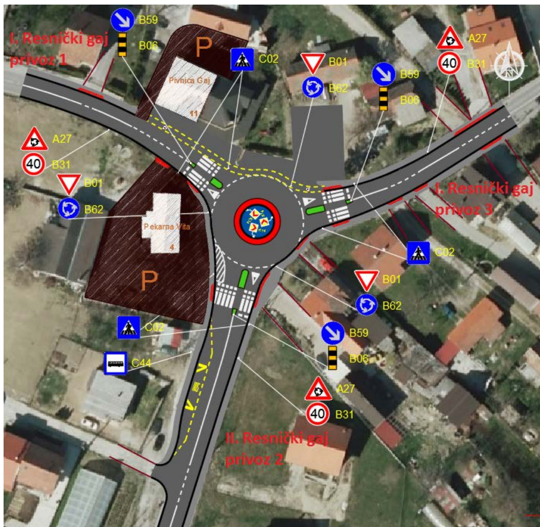
Slika 13. Tlocrt idejnog rješenja raskrižja izrađen u programskom alatu AutoCAD 2017
