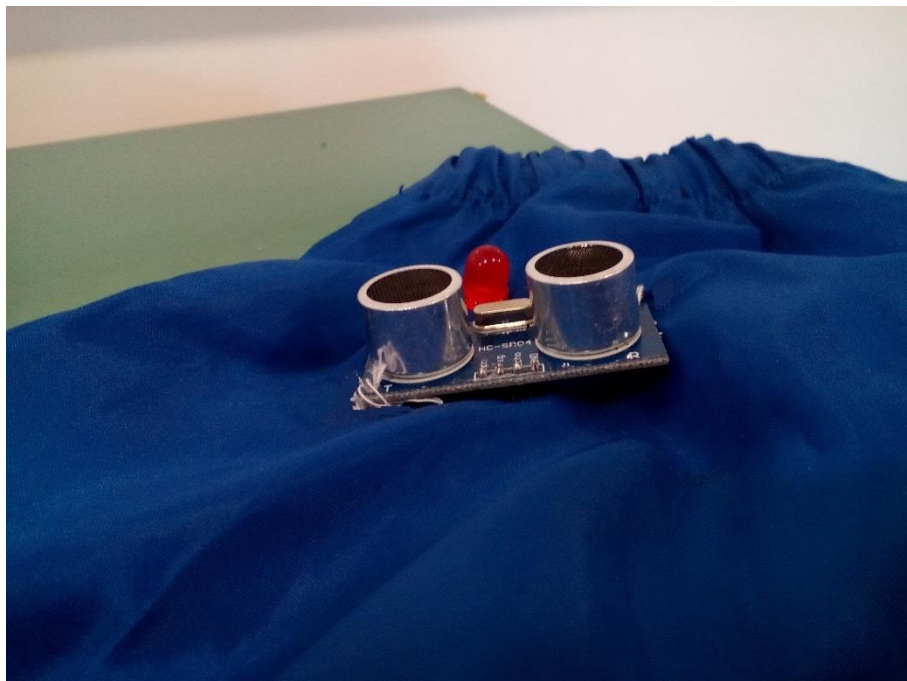
Slika 18. Ultrazvučni senzor i sigurnosna LED dioda
