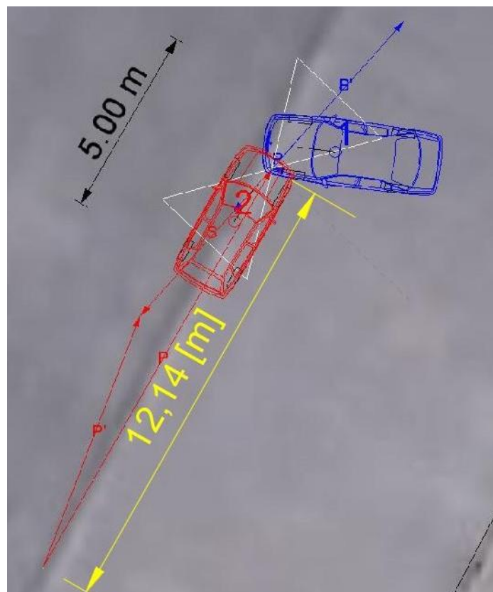
Slika 5.19. Impulsni dijagram vozila iz PC Crash programa
