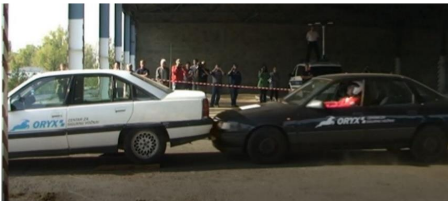
Slika 5.21. Nalet vozila straga – podlijetanje
