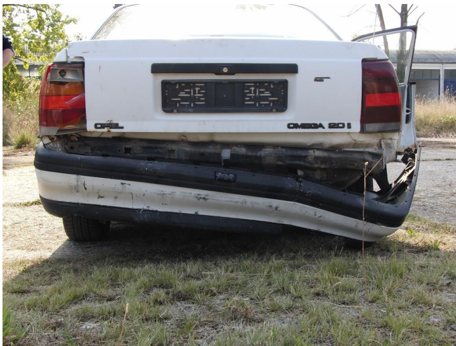
Slika 5.24. Oštećenja na vozilu Opel Omega
