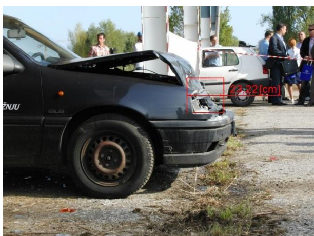
Slika 5.28. Dubina oštećenja vozila Opel Vectra
