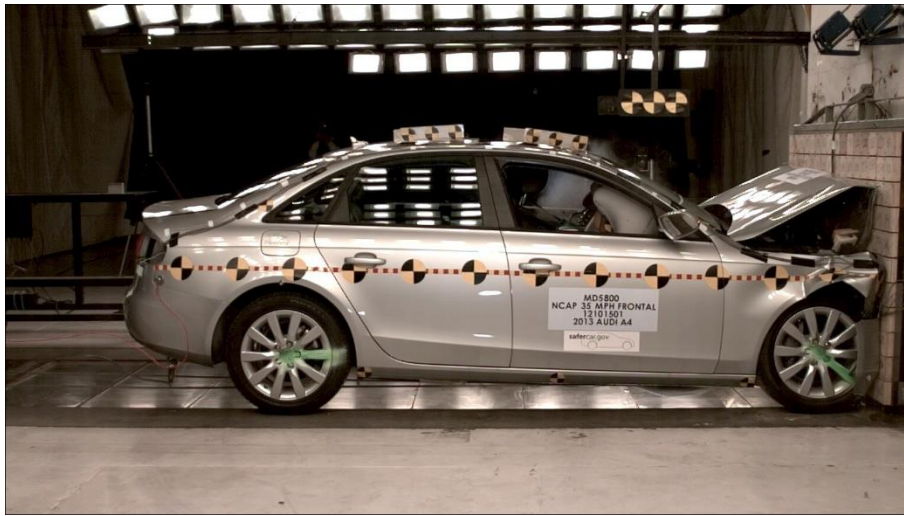
Slika 3.8. Frontalni nalet vozila na zid, [22]
