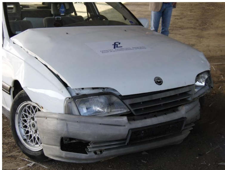
Slika 5.10. Oštećenja na vozilu Opel Omega - 2
