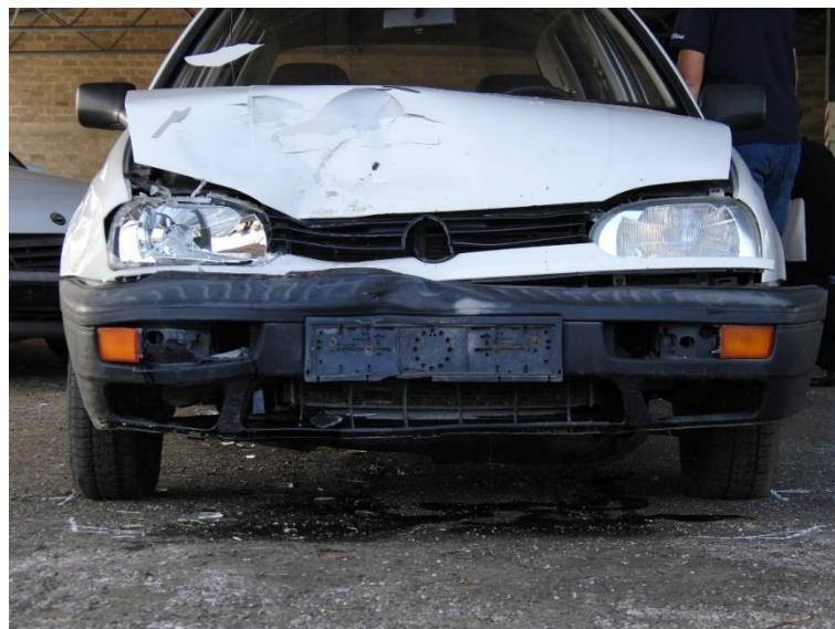
Slika 5.8. Oštećenja na vozilu VW Golf - 2
