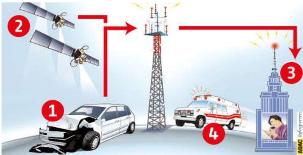
Slika 5. Shematski prikaz E - poziva
