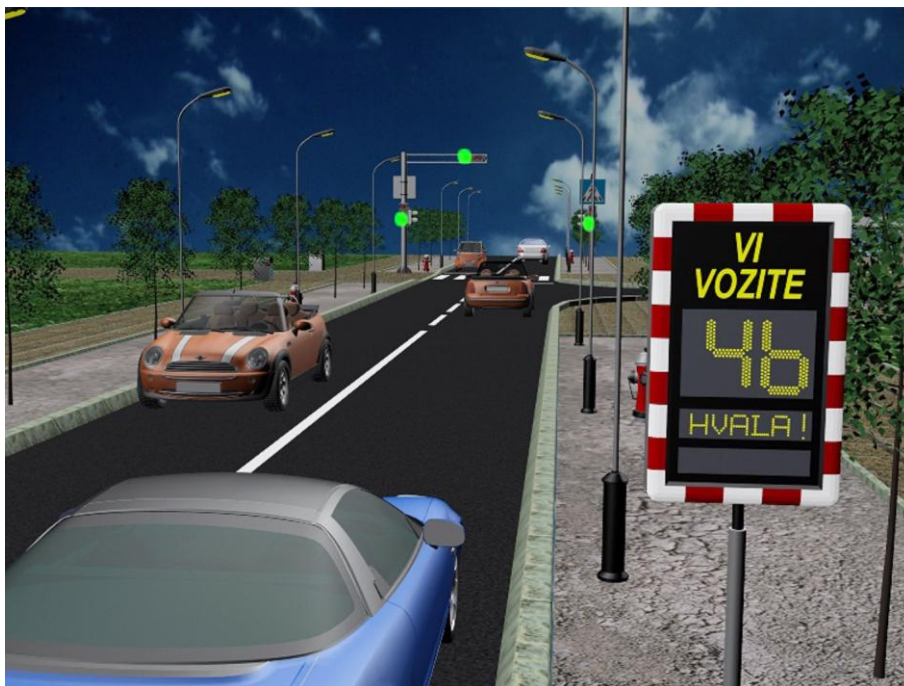
Slika 34. Detektor šalje poruku „HVALA“ kad je brzina zadovoljena
