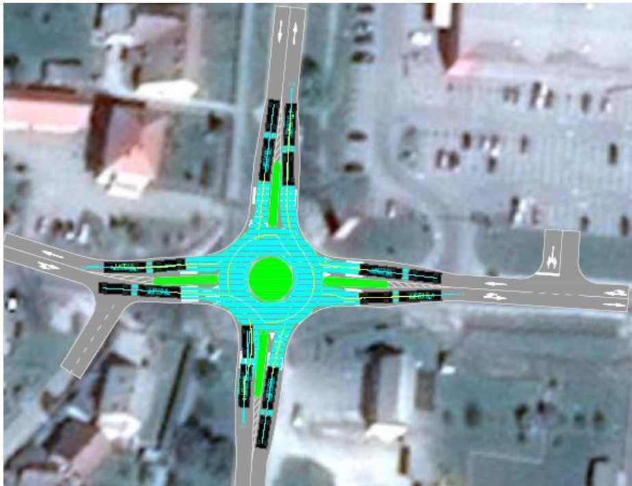
Slika 31. Provjerene trajektorije u programskom alatu AutoTURN za raskrižje Ulice kralja Tomislava – Ulice Ivana Gundulića – Ulice Marcela Kiepacha
