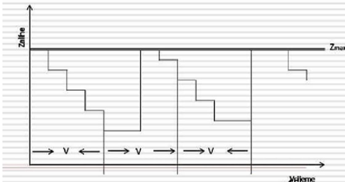
**Slika 5.** Kretanje zaliha kod sustava periodičnog nadzora
