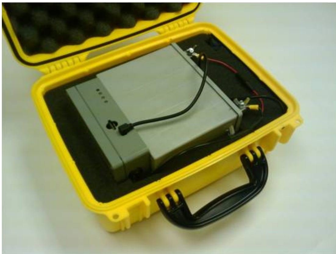
Slika 9. Blufax senzor u zaštitnoj kutiji [20]
