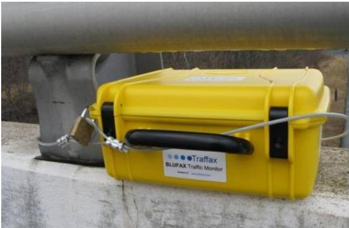
Slika 8. Blufax senzor u zaštitnoj kutiji [20]
