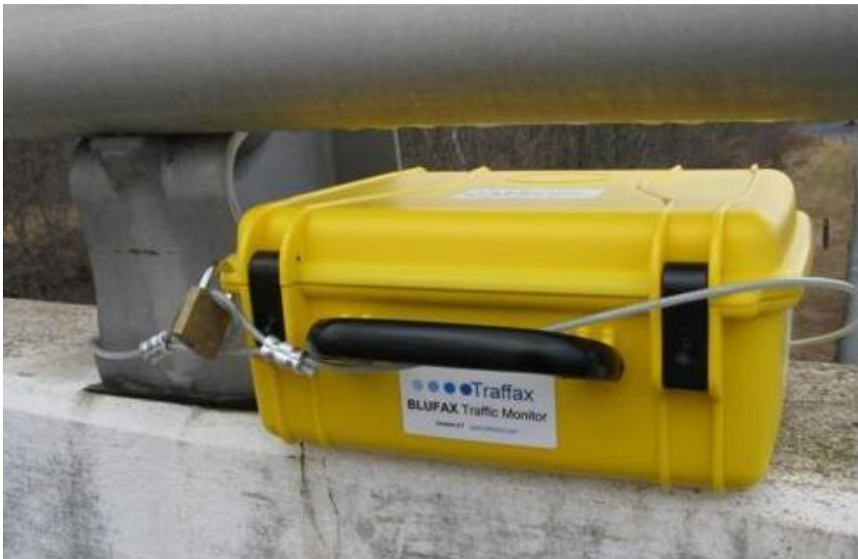
Slika 8. Blufax senzor u zaštitnoj kutiji [20]
