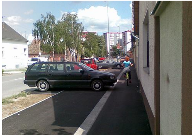
Slika 14. Nepovoljno vođenje biciklističkog traka uz parkirana vozila
