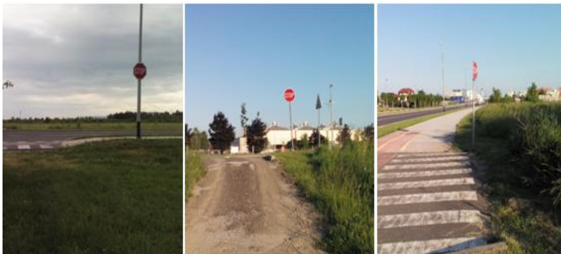
Slika 57. Primjeri nepotrebno postavljenih znakova „obvezno zaustavljanje“
