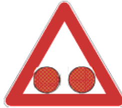
Slika 12. Svjetlosni znak za najavljivanje približavanje vlaka
