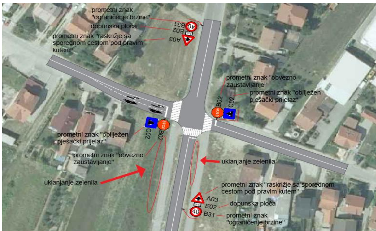
Slika 75. Idejno rješenje za raskrižje ulica Slavka Kolara i Nikole Tesle - Varijanta 1
