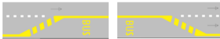
Slika 25. Otvaranje i zatvaranje prometnog traka namijenjenog vozilima javnog prijevoza putnika
