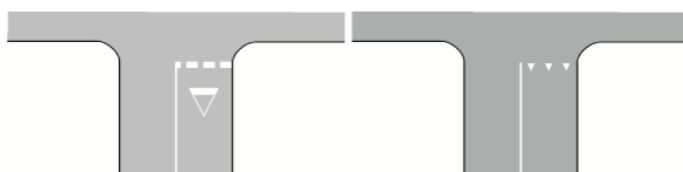
Slika 23. Isprekidana crta zaustavljanja
