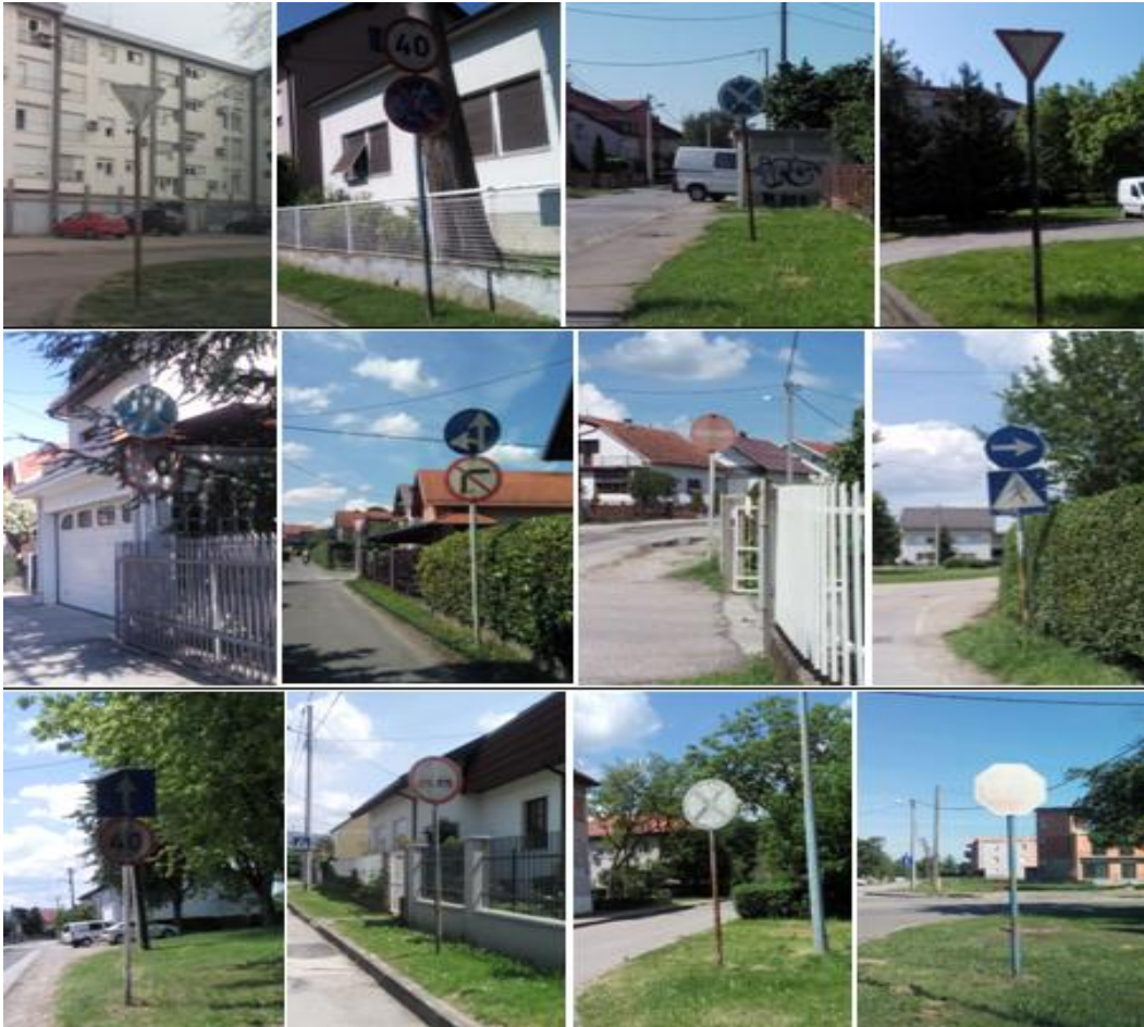
Slika 43. Primjeri prometnih znakova koje je potrebno zamijeniti zbog dotrajalosti
