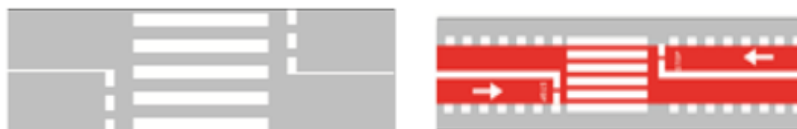
Slika 27. Pješački prijelazi preko kolnika i preko biciklističkih prometnica
