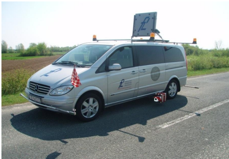
Slika 23. Mjerno vozilo sa montiranim uređajem ZDR 6020
