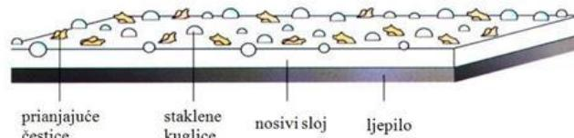
Slika 18. Nепрофилиране оznake na kolniku izrađene trakom
